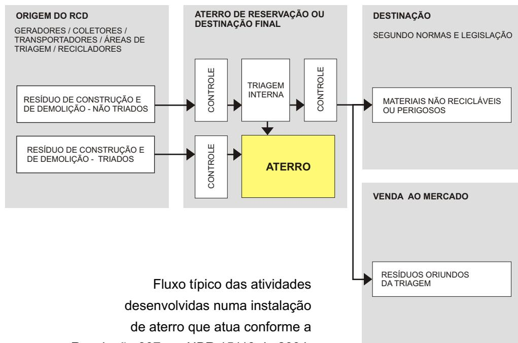
Fluxo típico das atividades desenvolvidas numa instalação de aterro que atua conforme a Resolução 307 e a NBR 15113 de 2004.
