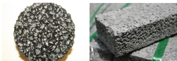
Figura 16: Camada porosa de revestimento (a) asfalto poroso CPA e (b) bloco de concreto poroso
