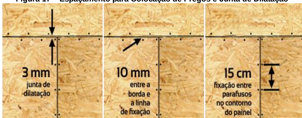
Figura 17 – Espaçamento para Colocação de Pregos e Junta de Dilatação
