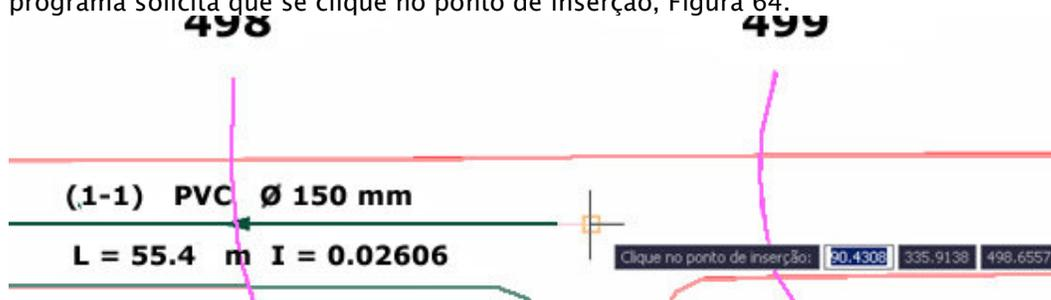
Figura 64. 1º passo para inserção do Terminal de Limpeza (TL)
