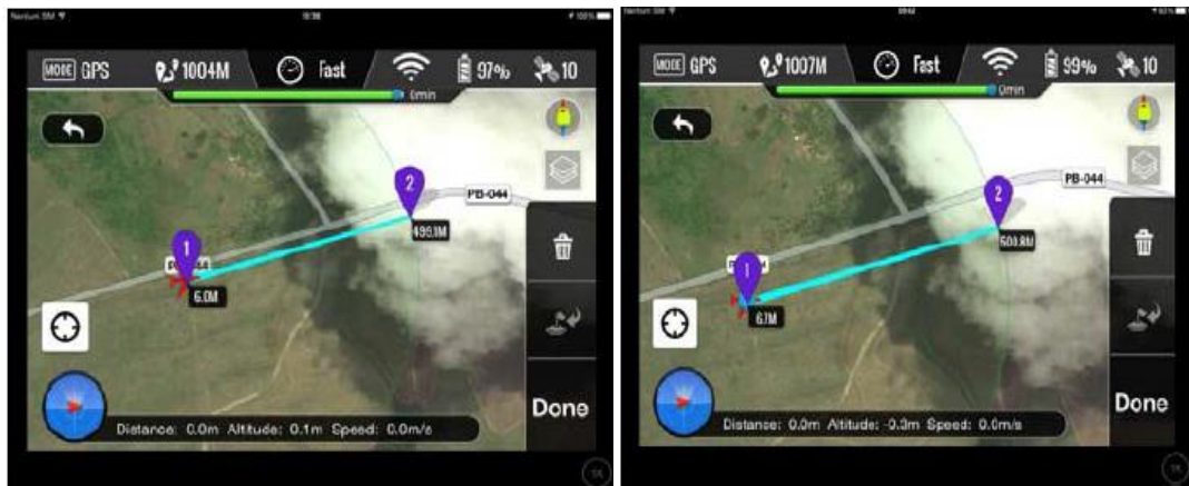
Figura 18: Vista do programa DJI Vision no módulo GroundStation, mostrando a faixa de vôo 2
