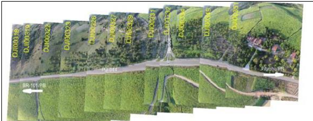
Figura 19: Vista do programa Microstation com o Mapa Índice não Controlado da Faixa 1.
