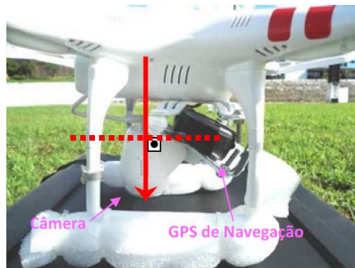
Figura 8: Adaptação do eixo de projeção para a posição perpendicular plano de referência
