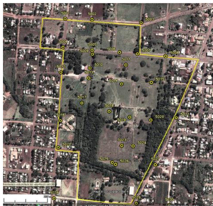
Figura 4: Exemplo de pontos de apoio para o VANT
